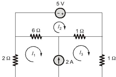
$$8I_1 - 6I_2 + 2I_3 - I_2 = 0 \quad \dots \text{(i)}$$
