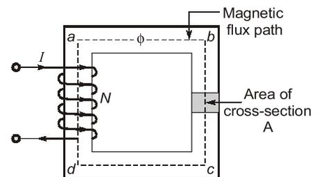
Fig. : Magnetic circuit
